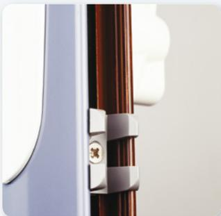
Le guide centreur permet le centrage du montant de tête sur le dormant lors de la fermeture, évitant ainsi que le crochet du verrou ne vienne endommager le dormant.
